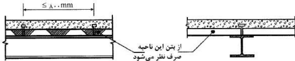
شکل ۱۰-۲-۸-۵ ورق‌های فولادی شکل داده شده که کنگره‌های آنها عمود بر محور تیر می‌باشد
