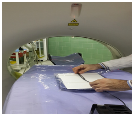
شکل (۶): نحوه قرار گیری اتاقک یونش در ناحیه هم مرکز دستگاه.
