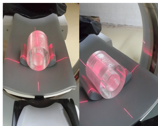
شکل (۴): نحوه قرار گیری فانتوم PMMA در ناحیه هم مرکز دستگاه.
