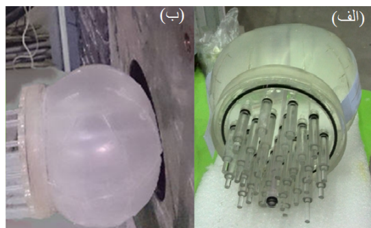
شکل (۲): (الف): نمایی از وارد شدن لوله در محور مرکزی فانتوم.
