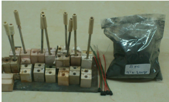
شکل (۱): پودر کاربرد بور، نمونه‌های کاربرد بور پوشش‌دهی شده و غلاف‌های سرامیکی
