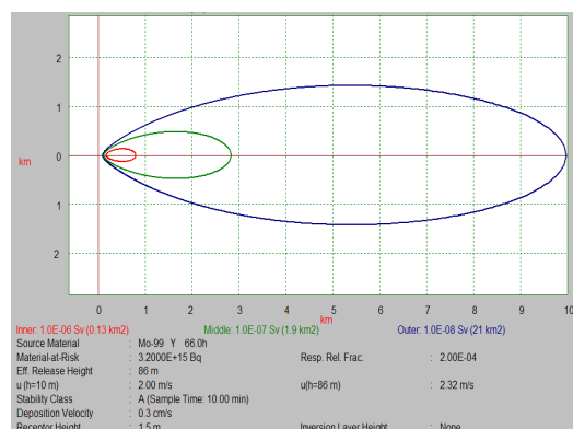
شکل (۵): میزان انتشار دز در اطراف راکتور برای کلاس A با سرعت باد ۲ m/s
