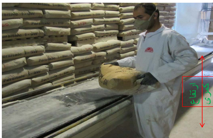
شکل ۳. افزایش ارتفاع نوار نقاله به ناحیه کمر افراد شاغل در کیسه‌گیری
