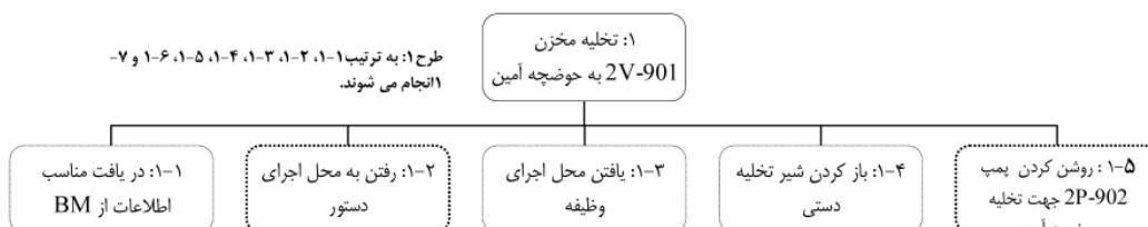
شکل ۲: آنالیز وظیفه تخلیه مخزن 2V-901
