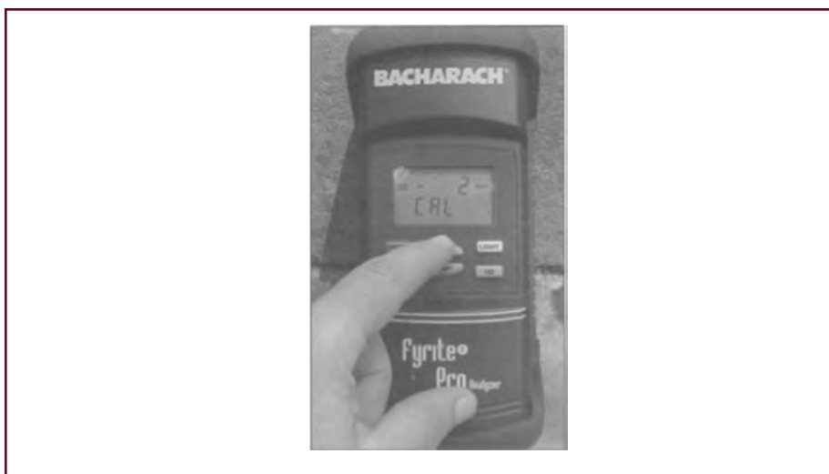
شکل ۸-۱: کالیبراسیون یک دستگاه قرائت مستقیم نوعی
