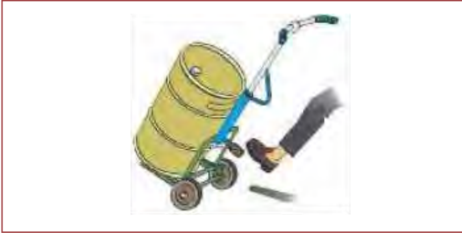
شکل ۳۴- گاری مخصوص حمل بشکه به منظور سهولت در حمل بار و جلوگیری از ایجاد آسیب به کارگر
