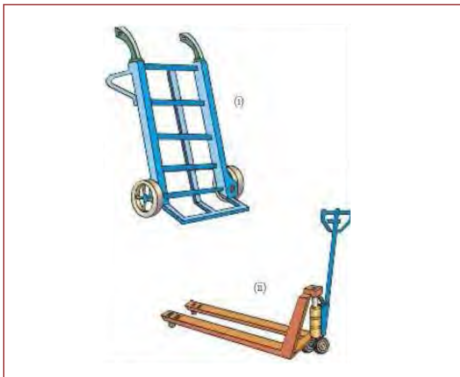
شکل ۳۲- استفاده از گاری و ترولی قابل اعتماد و ایمن جهت حمل بار های سنگین در مسافت های کوتاه
