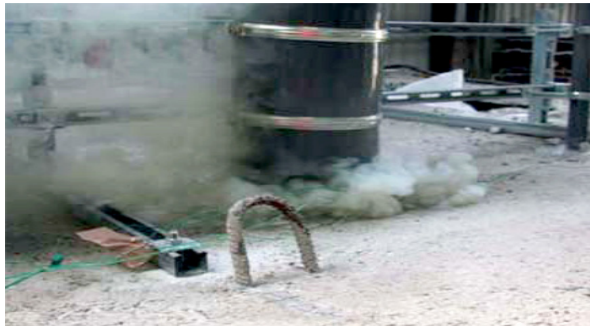
تصویر شماره ۳: دود تنها ۸ دقیقه پس از شروع آزمایش حریق از لوله پلاستیکی عایق بندی شده بیرون می آید.
