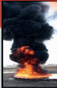
اطفاء ۱۰۰ مترمربع با ۳۰۰ لیتر گلازویل در ۱۰ ثانیه
