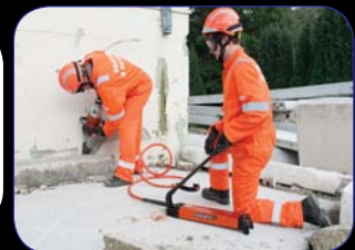
پمپهای دستی سری جدید، دو مرحله‌ای با وزن سبکتر و طراحی بهینه
