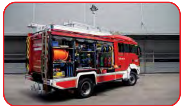
خودروی نجات مجهز به پمپ آتش نشانی
