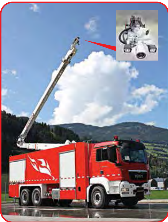
خودروی آتش نشانی صنعتی آب و فوم با بوم ۲۵ متری و سیستم نظارتی
