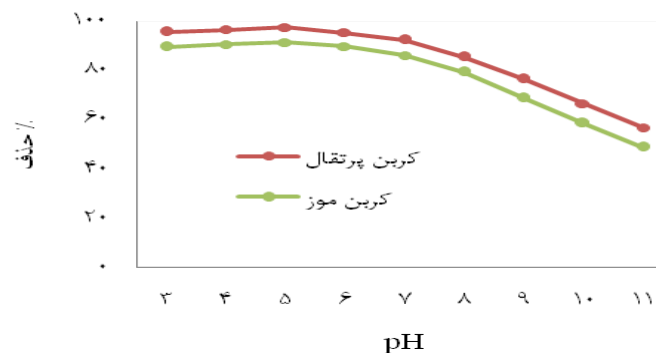
نمودار ۴. تأثیر pH بر روی کارایی حذف (دوز جاذب ۱ گرم در لیتر، غلظت ۲-کلروفنل ۲۵ میلی‌گرم در لیتر، زمان تماس ۶۰ دقیقه)
