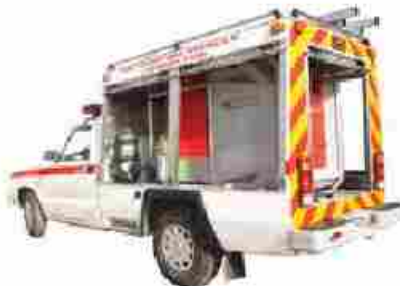
خودروی آتش نشانی با سیستم واتر میست
