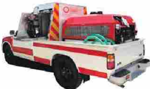
خودروی آتش نشانی با سیستم واتر میست
