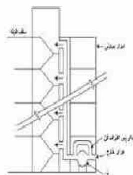
شکل ۱۳ - سامانه فشار مثبت پلکان با بایوس اطراف فن خیرانی، شکل B.3
