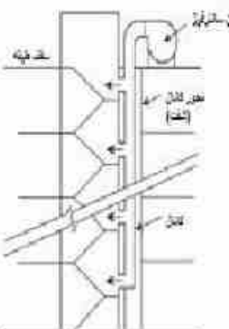
شکل ۱۱ - سامانه فشار مثبت پلکان بوسیله فن نصب شده در سقف و چندین تزریق (شکل b) A5.3.4
