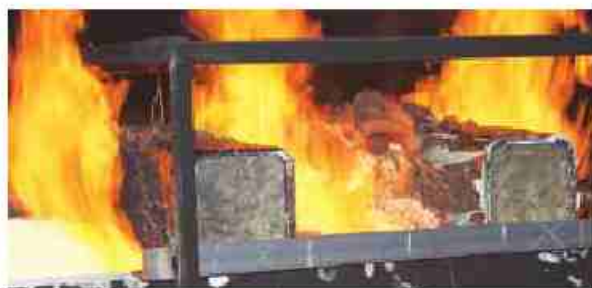
شکل ۱. آزمایش رنگ‌های متورم‌شونده. بخش‌هایی از سطح روبه نمونه در قسمت راست در حین آزمایش سقوط کردند.
