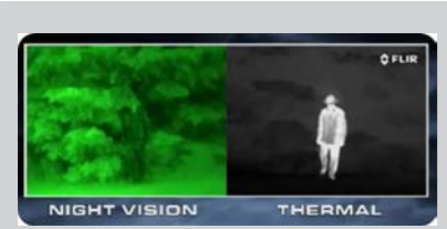
شکل شماره ۱- قابلیت شناسایی هدف با کنتراست نور کم در تاریکی مطلق توسط دوربین‌های حرارتی CVS مادون قرمز
