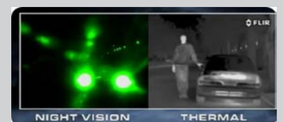
شکل شماره ۴- نیاز دوربین‌های دید در شب معمول به حداقل میزان مشخص نور جهت نمایش تصویر برخلاف دوربین‌های حرارتی (CVS)
