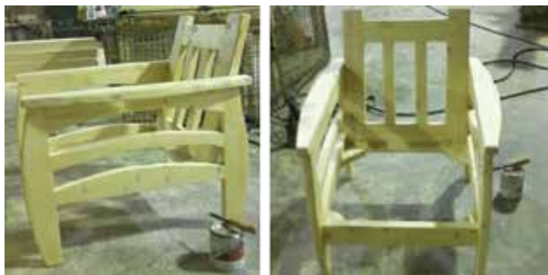
شکل ۲: کلاف (اسکلت) مبل نمونه، ساخته شده بر اساس ابعاد به دست آمده
