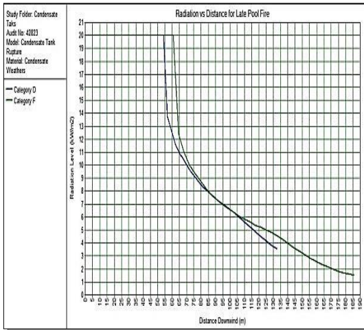
شکل ۴: مقدار تشعشعات بر حسب فاصله در تخلیه ناگهانی مخزن
