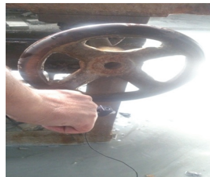
تصویر ۱: اندازه‌گیری ارتعاش دست و بازو در حین کار با دستگاه برش عرضی و برش طولی
