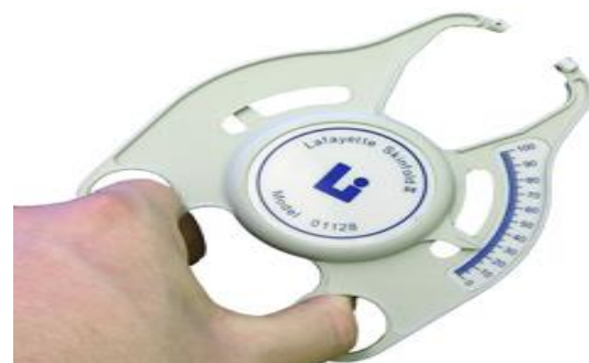
شکل ۱: کالیپر برای اندازه‌گیری میزان درصد چربی بدن
