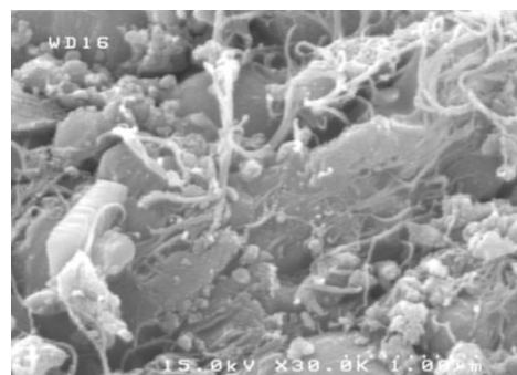
شکل ۱- تصویر میکروسکوپ الکترونی روبشی (SEM) جاذب کامپوزیتی سیلیکاته نانولوله کربنی (CNTs)
