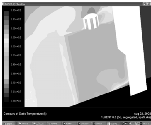
تصویر ۱۳- کانتور دمای استاتیک در مقطع، مدل ۲ (ماخذ: نگارنده)
