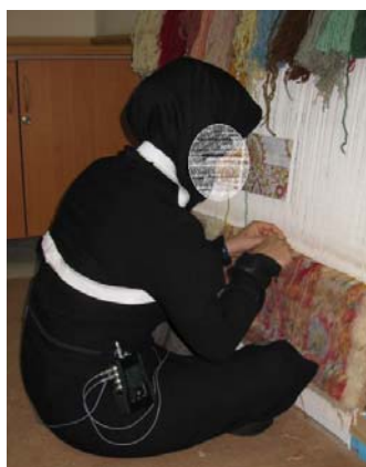
شکل ۱- قالیبافی به صورت سنتی و نحوه قرار گرفتن سنسور بر روی ناحیه جناق سینه
