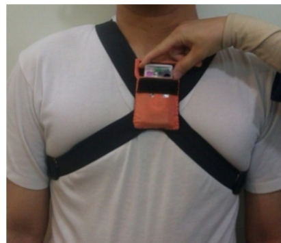
شکل ۲- تصویری از محل و نحوه نصب دستگاه شیب سنج الکترونیکی
