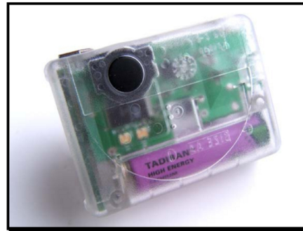
شکل ۱- تصویری از شیب سنج الکترونیکی
