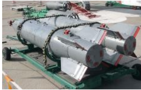
تصویر ۳-۹ - ۴ باله ثابت انتهایی بمب
