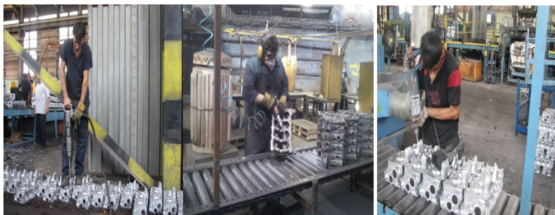
شکل ۱. ابزار مرتعش استفاده شده در شرکت ریخته‌گری قطعات خودرویی در این مطالعه
