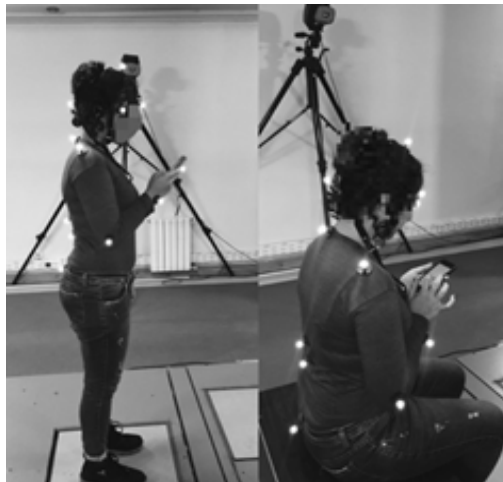
شکل ۱. محل اتصال مارکرها به آزمودنی‌ها در دو وضعیت نشسته و ایستاده
