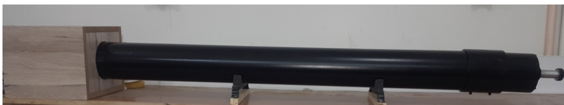
شکل ۱: لوله امپدانس نسبت موج ایستا مدل 9410 شرکت آوا سینا
