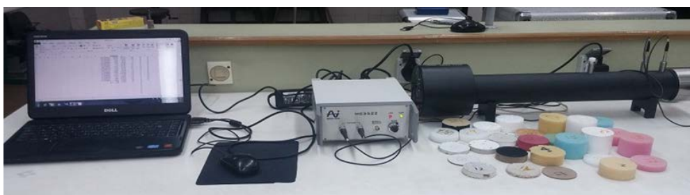
شکل ۲: لوله امپدانس مدل SW260 شرکت BSWA به همراه برخی از نمونه‌های مورد مطالعه
