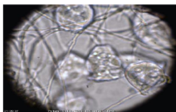
شکل ۶: حضور اجتماع هایی از سیلیاته های ساقه دار (ورتیسیلا) در راکتور (تصاویر تهیه شده توسط میکروسکوپ نوری)
