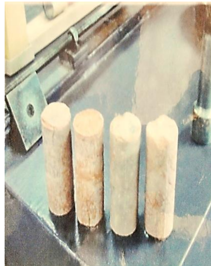
شکل ۵- نمایش نحوه انجام آزمایش تک محوری تعیین مقاومت فشاری خاک های رسی مخلوط با آهک
