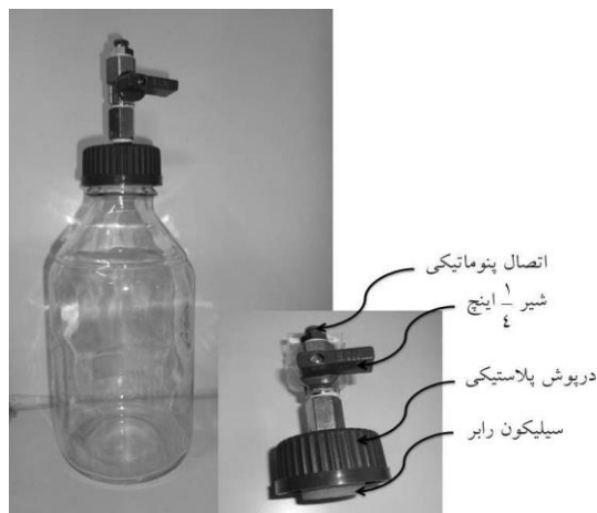
شکل ۱- هاضم مورد استفاده در این پژوهش
