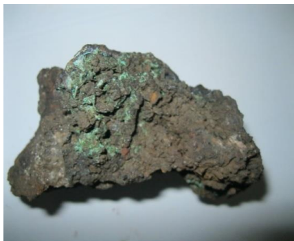
شکل ۵- نمونه سنگ آهن با ترکیب اصلی هماتیت و کانی‌های فرعی گوتیت و مالاکیت (کربنات مس)
