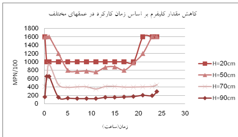
نمودار ۶- کاهش باکتریهای کلی فرم در عمقهای مختلف برای بستر ریزدانه و کدورت آب خام ورودی ۱۰ NTU
