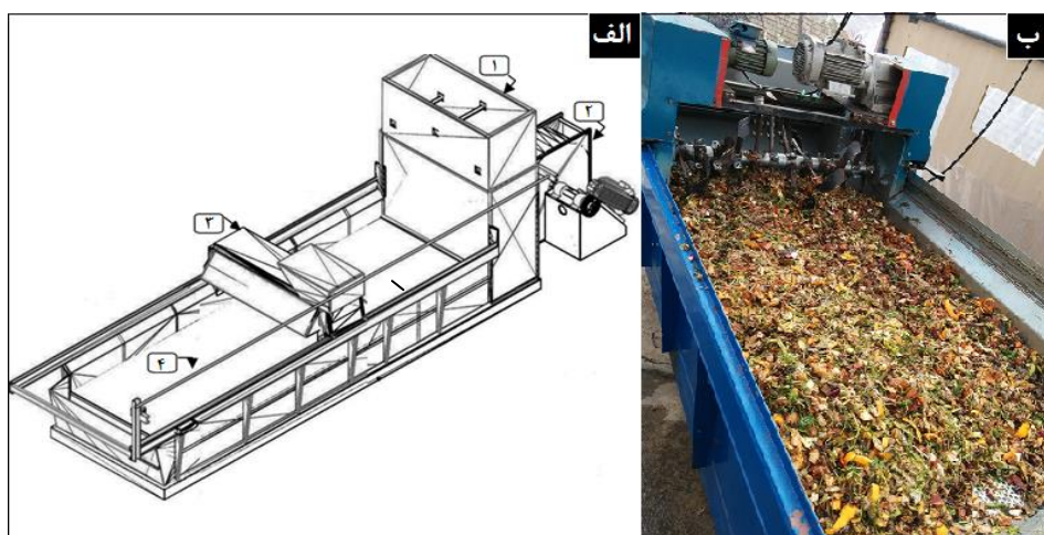
شکل (۱-الف) - تصویر شماتیک دستگاه تولید کمپوست ۱- محل ورود زباله ۲- دمنده ۳- کالسکه و پارو ۴- سطح
