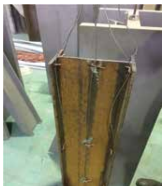
شکل ۲: تیر آهن مورد آزمایش بعد از نصب ترموکوپل
