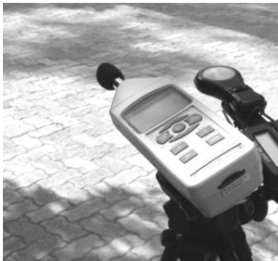
تصویر ۲- دستگاه تراز سنج صوت مورد استفاده در پژوهش
