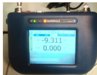
شکل (۳): نمایی از دستگاه الکترومتر به‌منظور اندازه‌گیری جریان الکتریکی نمونه‌ها.
