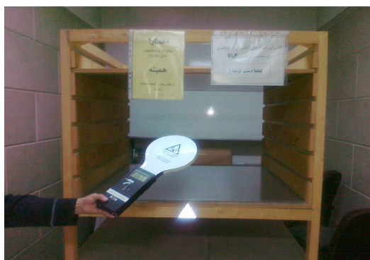
شکل (۳): کالیبراتور میدان الکتریکی.
