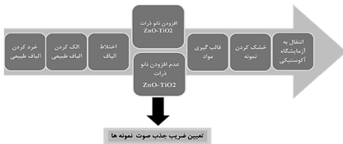
شکل ۲. مراحل ساخت نمونه های جاذب صوتی
