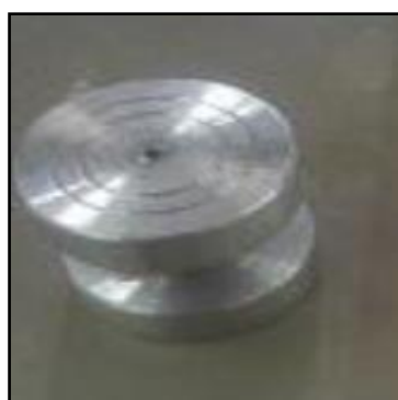
شکل ۱۰- قالب تهیه قرص در دستگاه FT-IR
