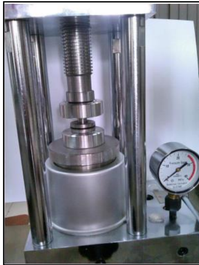
شکل ۱۱- دستگاه پرس در دستگاه FT-IR
