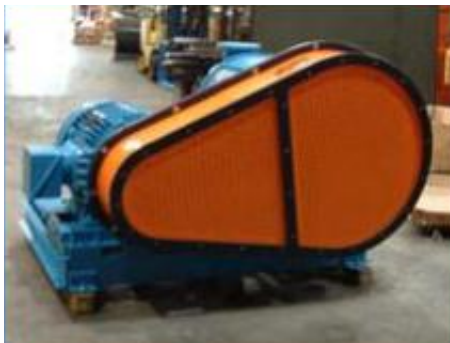
حفاظ گذاری تجهیزات انتقال نیرو
