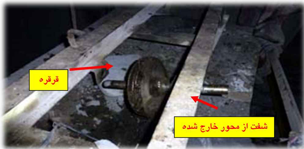
شکل ۷- قرقره و شفت از محور خارج شده بالابر حادثه دیده
