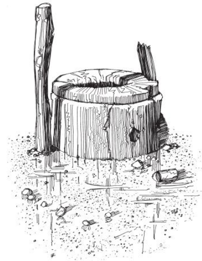
شکل ۱۵-۳. یک چاه آسیب دیده، ترک‌های روی دیواره نشان داده شده است.
