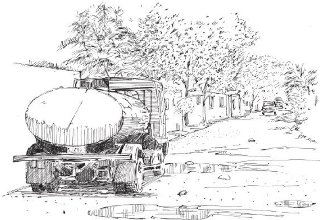
شکل ۱۲-۴. آسیب‌های وارد شده به جاده به وسیله تانکرهای آب
