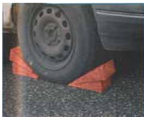
موانع ثبیت باید بوسیله گوه محکم و با فشار مناسب جهت اتصال بدون سر خوردگی قرار گیرند.
