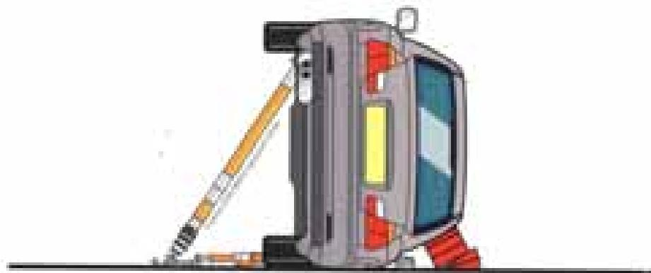
برای اطمینان از واژگون نشدن خودرو، با قرار دادن پایه هایی در نقاط A و C آنرا حمایت کنید. در کار خود دقต کنید، از قرار دادن وسایل ثابت سازی در محل هایی که احتمال بریده شدن آن است اجتناب کنید.
