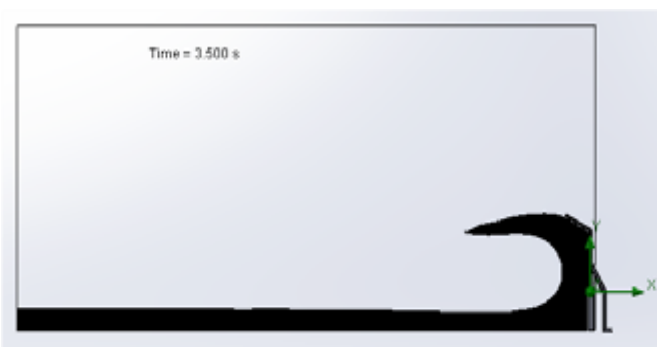
عملکرد بانداوال دارای سپر پاششی در هنگام تخریب ناگهانی مخزن
