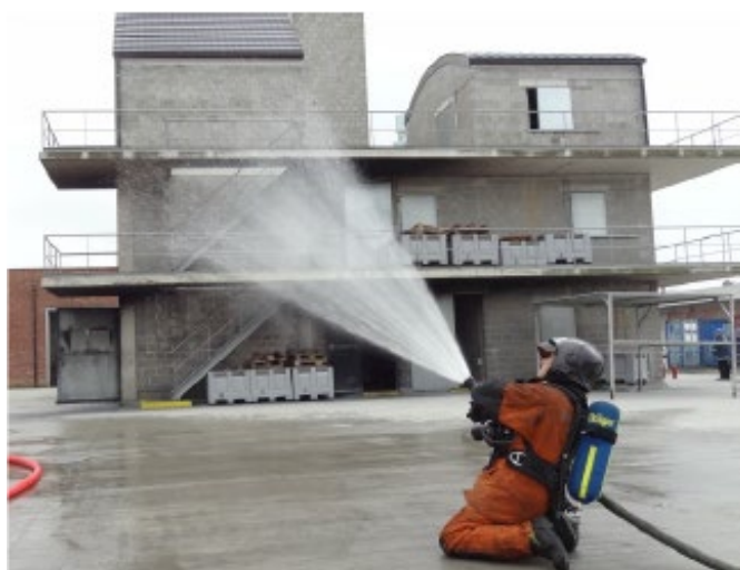
استفاده از پالس کوتاه زاویه بین نازل و زمین، ۴۵ درجه و زاویه مخروط اسپری آب، بین ۴۰ تا ۶۰ درجه
