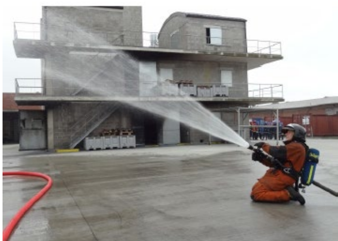
استفاده از پالس طولانی زاویه بین سرلوله و زمین، ۳۰ درجه و زاویه مخروط اسپری آب، ۳۰ درجه
