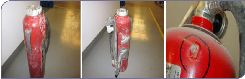
شکل ۸-۶. به روز دفرمگی در اثر ضربه به خاموش کننده
