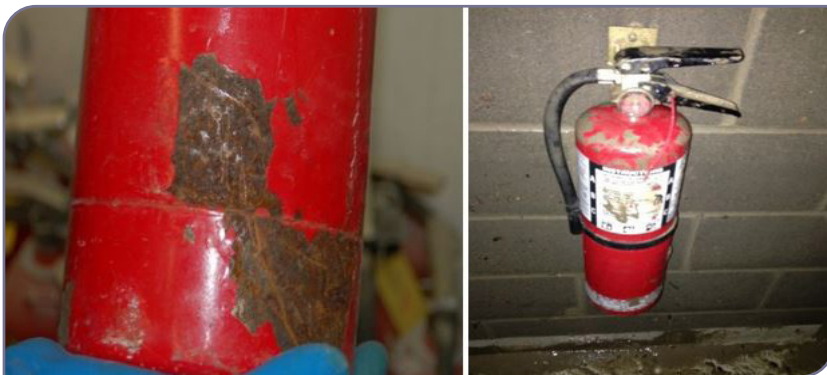
شکل ۱۱-۶. از بین رفتن رنگ خاموش کننده
