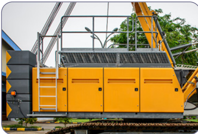
شکل ۱۴-۲. جرثقیل متحرک با کشنده زنجیری یا شنی
