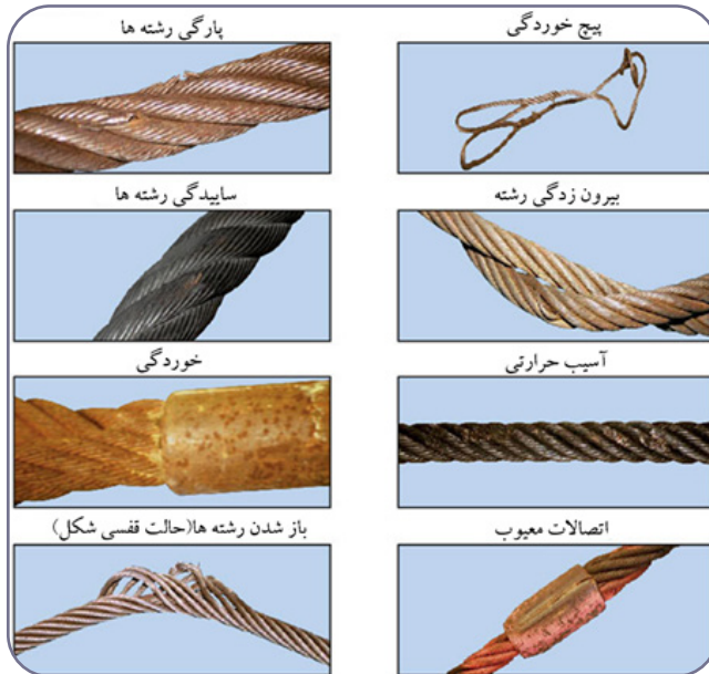
شکل ۴-۴. عیوب سیم‌بکسل‌ها
