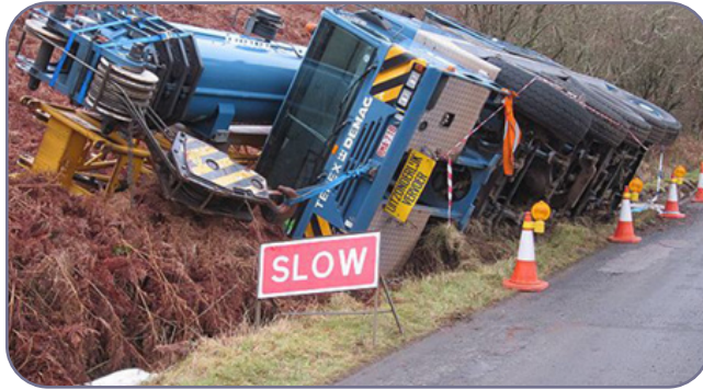
شکل ۶-۵. واژگونی جرثقیل متحرک در هنگام جابه‌جایی
