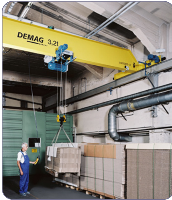
شکل ۱۸-۲. کاربرد در حال هدایت جرثقیل سقفی توسط صفحه کلید آوین
