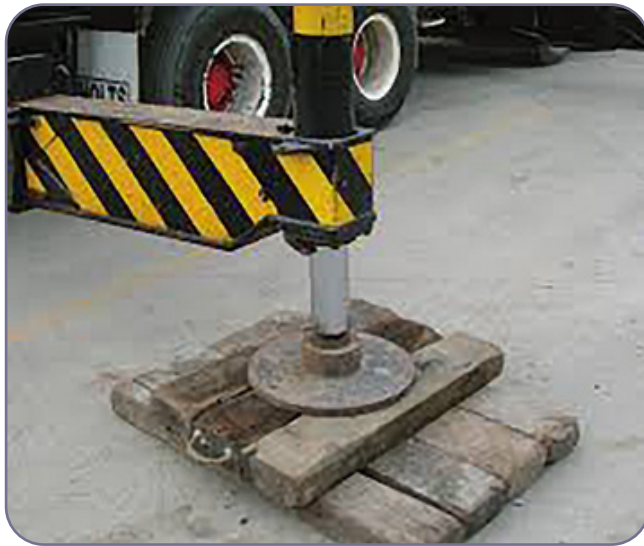
شکل ۱۵-۵. استفاده از دو ردیف تراورس زیر کفشک جک
