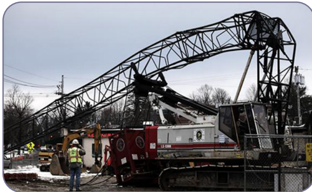
شکل ۸-۵. تغییر شکل بوم مشبک در اثر گیرکردن قلاب به قرقره انتهایی بوم
