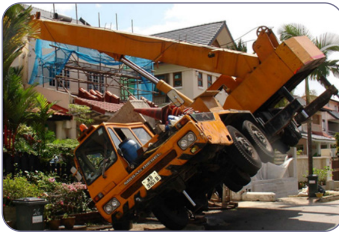
شکل ۶-۵. واژگونی جرثقیل متحرک به دلیل استفاده ناصحیح از جک‌های تعادلی
