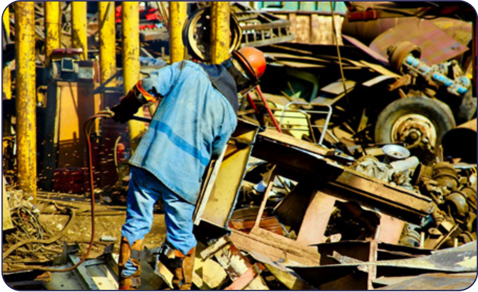
شکل ۳-۴. کارگر در حال برش کاری و جداسازی ضایعات آهن به وسیله مشعل اکسیژن در کارگاه قراضه. عکس از Jessica Palomo در Unsplash
