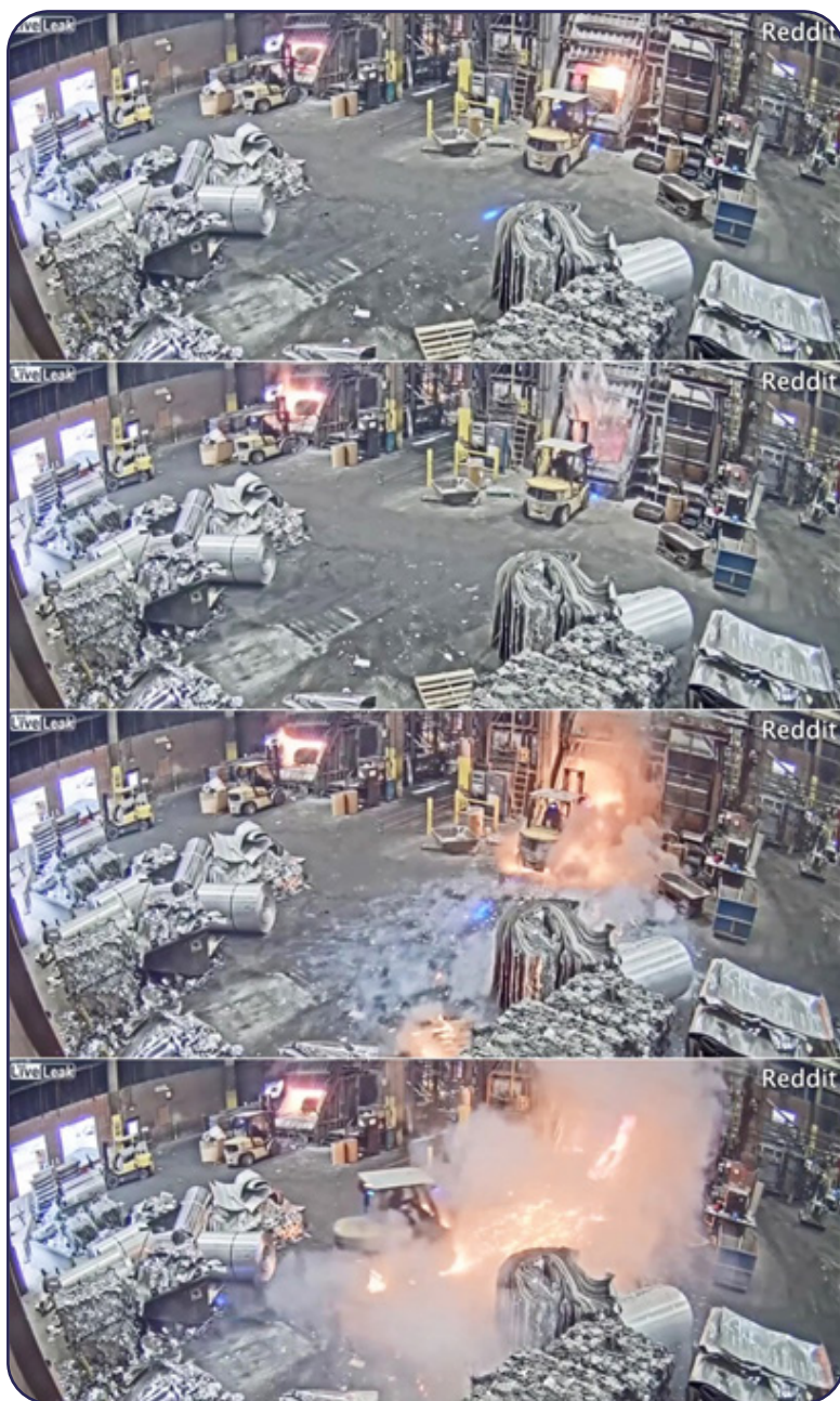
شکل ۱-۵. انفجار بخار در کوره ذوب آلومینیم، گزارش دیلی میل، دسامبر ۲۰۱۹ در چهار قاب.
