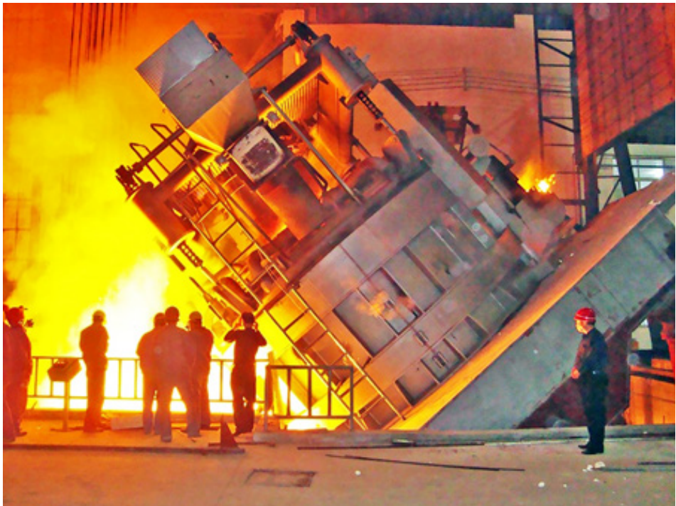
شکل ۱۸-۳. اگرچه کوره‌های قوس الکتریک معمولاً کارکرد خودکار دارند و عملیات ذوب در آن‌ها طبق استاندارد انجام می‌گیرد، اما در هنگام کار آن، معمولاً چند گروه در کارگاه مشغول به کار هستند و مخاطرات ایمنی مختلفی ممکن است وجود داشته باشد. عکس از GT Engineering
