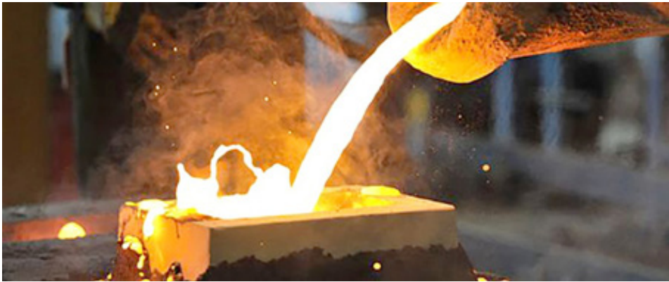
شکل ۱۰-۳. هنگام بارریزی در قالب، ممکن است مذاب تا فاصله ۱۰ متر یا بیشتر پرتاب شود. پاشش مذاب در تماس با اشیایی که رطوبت دارند می‌تواند منجر به حادثه شود. عکس از metal works
