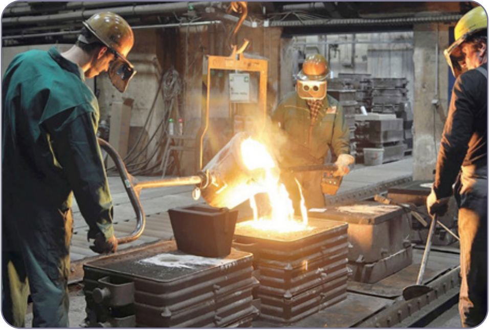
شکل ۱۶-۲. بارریزی چدن در قالب ماسه‌ای با پاتیل ۱۰۰ kg
