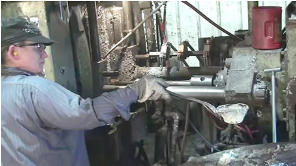
شکل ۱۳-۳. کارگر در حال بارریزی آلومینیم مذاب در ماشین دایکست کارخانه دایرس ویل دایکست Dyersville Die Cast ۱ . اطراف محفظه پیستون و پشت قالب دایکست پلیسه‌های آلومینیم چسبیده دیده می‌شود که نشان می‌دهد پاشش مذاب بارها اتفاق افتاده است.
