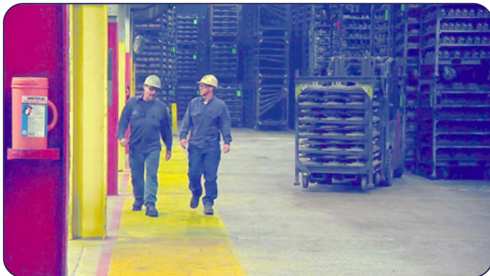
شکل ۱-۴ کنترل مخاطرات مکانیکی در کارگاه‌ها با ایجاد گذرگاه ایمن برای رفت‌وآمد افراد.
