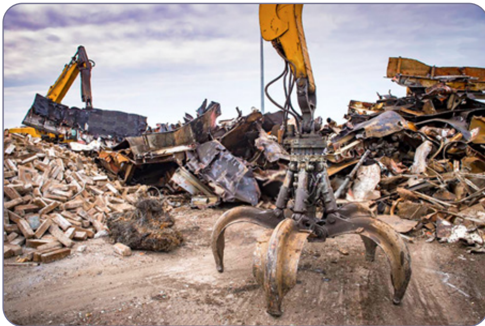
شکل ۱۴-۳. در کارگاه قراضه ماشین‌آلات سنگین مانند چنگ، قیچی، مگنت و پرس وجود دارند. در این شرایط خطر لغزش، سقوط و ریزش مواد زیاد است. همچنین مخاطرات شیمیایی و زیستی در مواد بازیافتی قابل توجه است.
