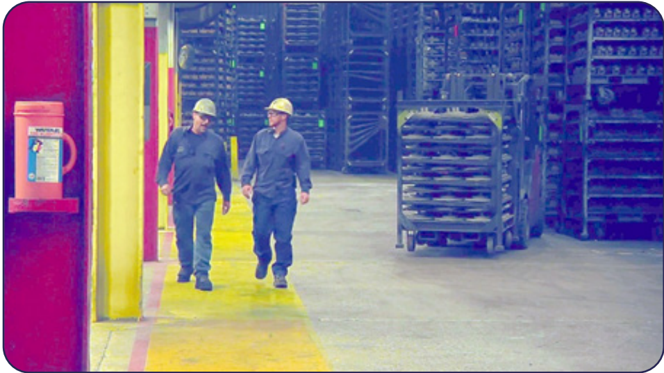
شکل ۴-۱ کنترل مخاطرات مکانیکی در کارگاه‌ها با ایجاد گذرگاه ایمن برای رفت و آمد افراد.
