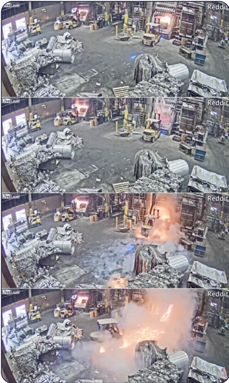
شکل ۱-۵. انفجار بخار در کوره ذوب آلومینیم، گزارش دلی میل، دسامبر ۲۰۱۹ در چهار قاب.
