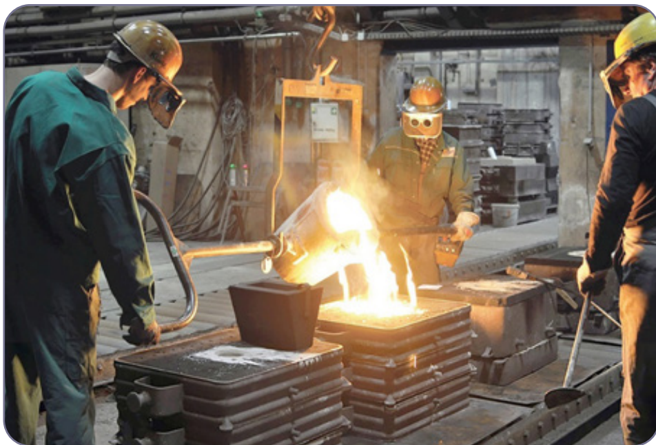
شکل ۲۰-۲. بارریزی چدن در قالب ماسه‌ای با پاتیل ۱۰۰ kg
