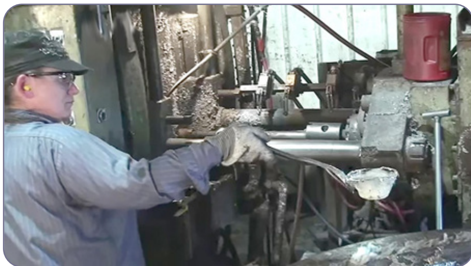
شکل ۱۳-۳. کارگر در حال بارریزی آلومینیم مذاب در ماشین دایکست کارخانه دایرس‌ویل دایکست Dyersville Die Cast ۱ . اطراف محفظه پیستون و پشت قالب دایکست پلیسه‌های آلومینیم چسبیده دیده می‌شود که نشان می‌دهد پاشش مذاب بارها اتفاق افتاده است.
